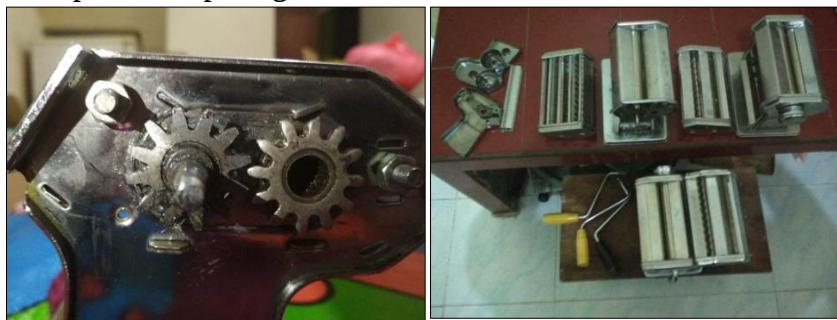
Gambar 2. Gigi Cetakan yang sering Rusak, Gambar 3. Cetakan yang Gigi Cetakannya Rusak
