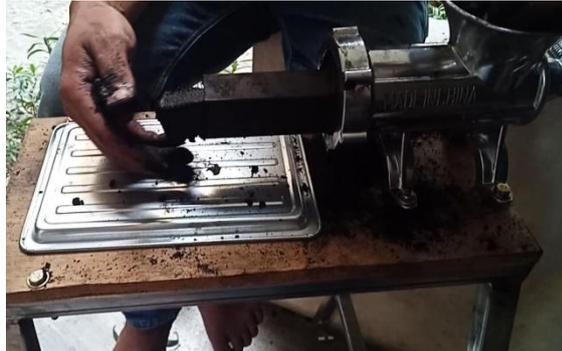
Gambar 9. Proses Pencetakan Briket Tongkol Jagung
